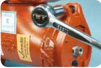
Quite un perno y una tuerca para acceder al sistema
